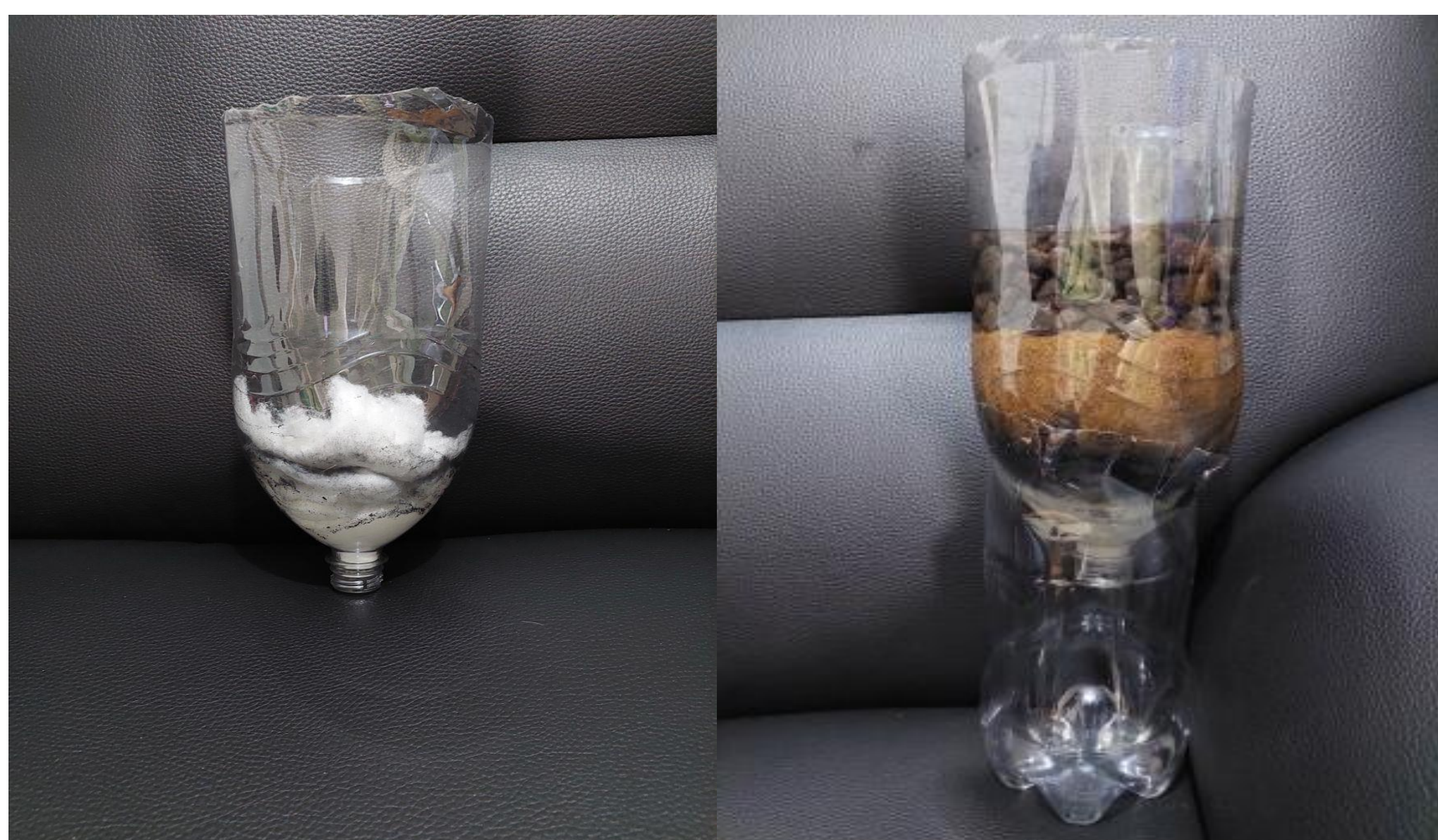
Figura 1 - Construção do filtro de água caseiro. Fonte: Autoria própria.
